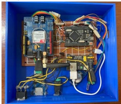
Nota: Armado de cada uno de los componentes del proyecto en la caja impresa en 3D
