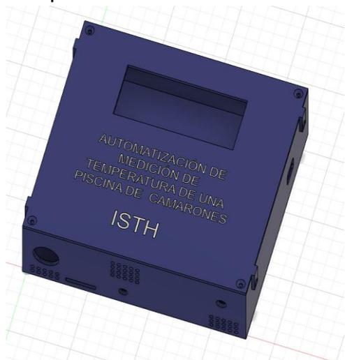
Nota: Se presenta el diseño en 3d realizado en fusión 360 de la caja en donde se colocará la parte electrónica del prototipo.
