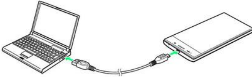
Figura 6. Conexión vía usb del dispositivo móvil
